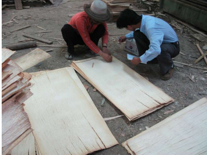
Hình 4.16. Vá ván bằng băng keo
