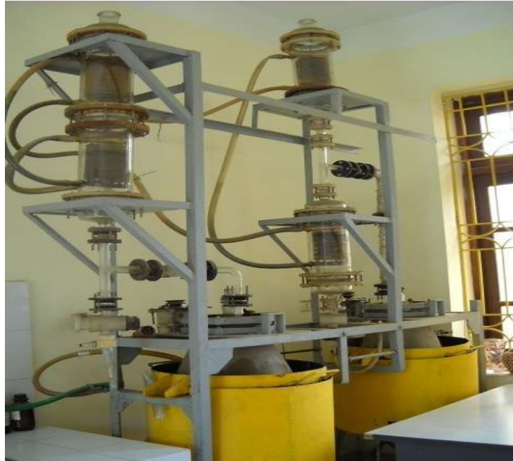
Hình 1: Hệ thống chưng cất lôi cuốn (khoảng 5 kg/mẻ)
