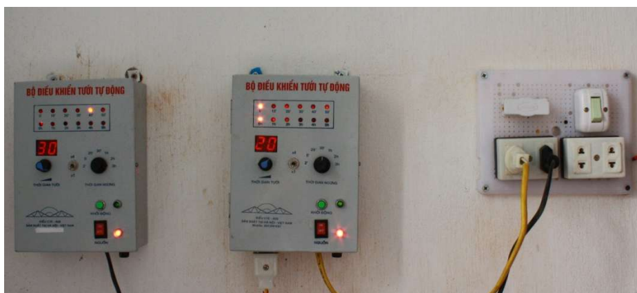
Hình 9 : Bộ điều khiển tưới tự động được trang bị cho VGH thôn/bản
