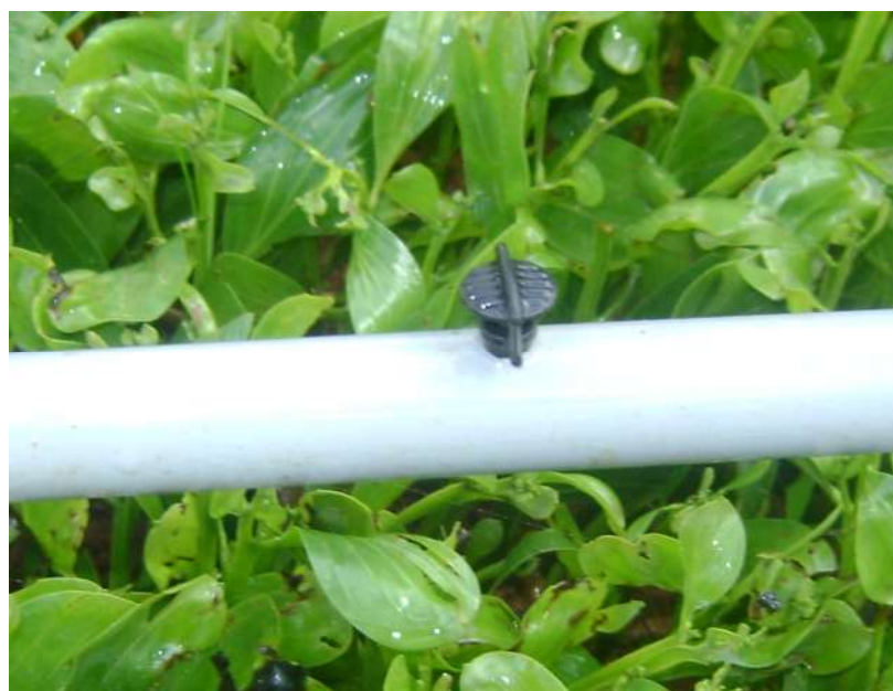
Hình 5: Vòi phun Toro (Úc) được lựa chọn cho hệ thống tưới phun sương
