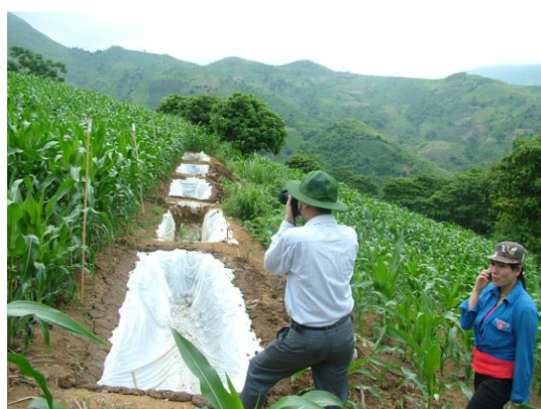
Hình 4. Hồ hứng đất xói mòn trong thí nghiệm canh tác ngô bền vững
