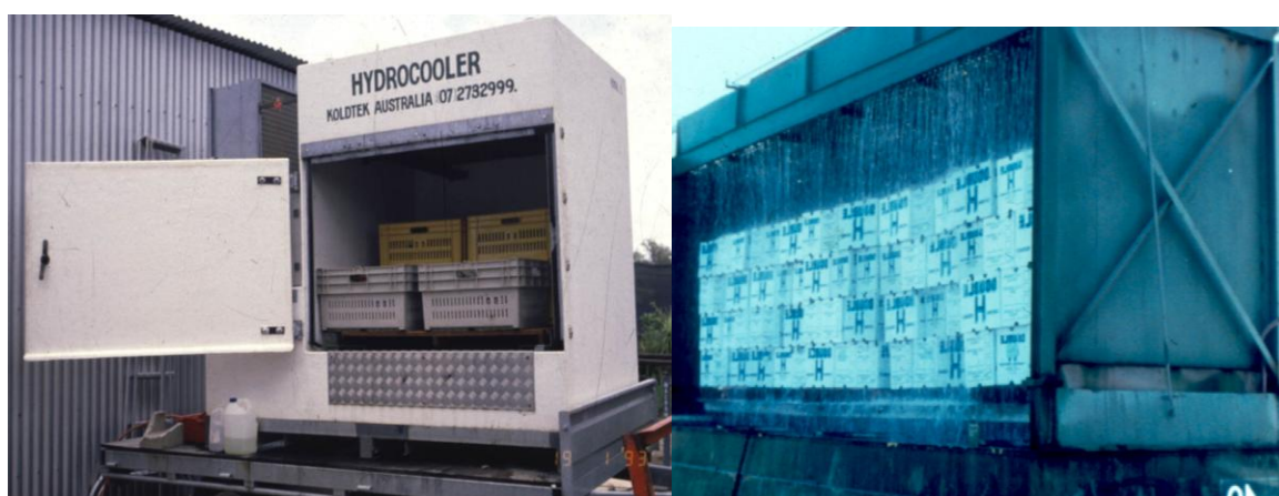
Hình 3.9. Làm lạnh bằng nước lạnh
