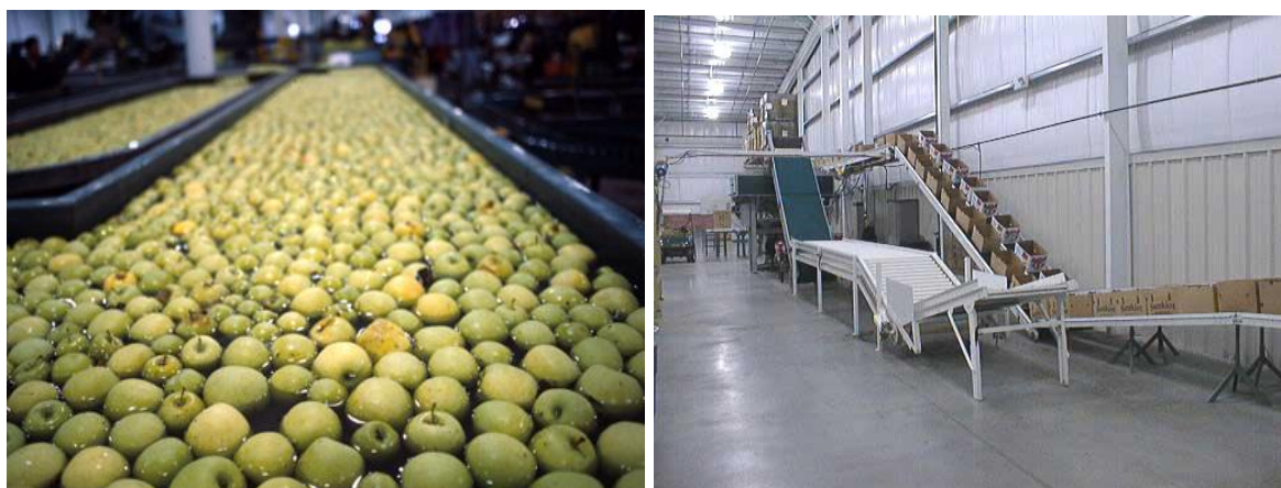
Hình 3.1.5. Dây chuyền rửa - xử lý – đóng gói quả
