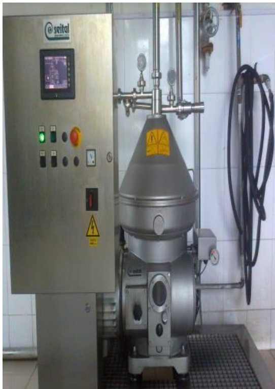
Hình 2.2. Thiết bị lọc sữa kiểu ly tâm
