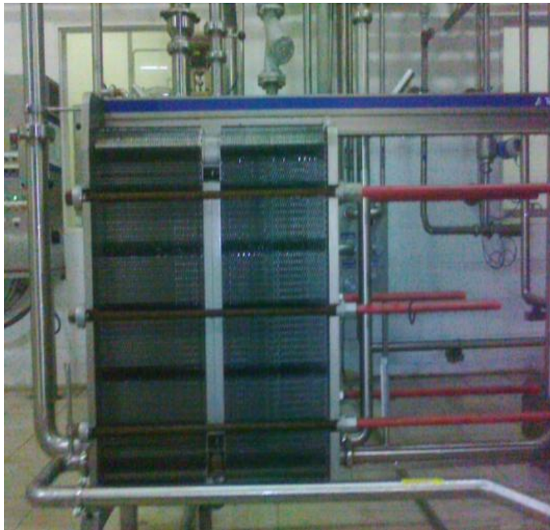
Hình 3. 4. Thiết bị trao đổi nhiệt dạng tấm bản.
